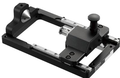
対象物を固定するためのツールです。測定ステージの上に置くと傾いてしまう対象物などを測定するときに効果を発揮します。
